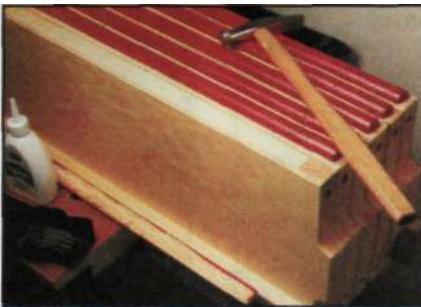
*Бруски полукруглого сечения временно, пока не отвердеет клей, прихватывают тонкими гвоздиками. Лунки от гвоздей потом заполнит лак.*
