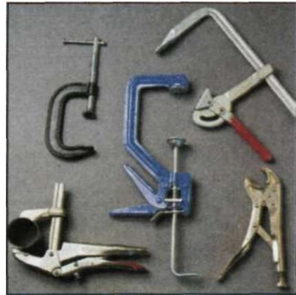
*Зажимы для работы с металлическими деталями. Сверху - цельнометаллические струбцины с поворотным винтом, подвижной штангой или эксцентриком. Внизу - клещи, надежно удерживающие и детали круглого сечения.*
