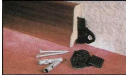
Монтаж вставных плинтусов на зажимах, прикрепленных к стене через каждые 50 см.
