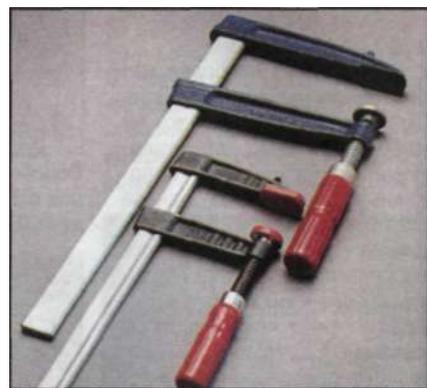
Для каждого случая нужна своя струбцина. Вверху - струбцина с большой рабочей глубиной, внизу — струбцина с защитными пластиковыми губками, предназначенная для склеивания небольших изделий.
