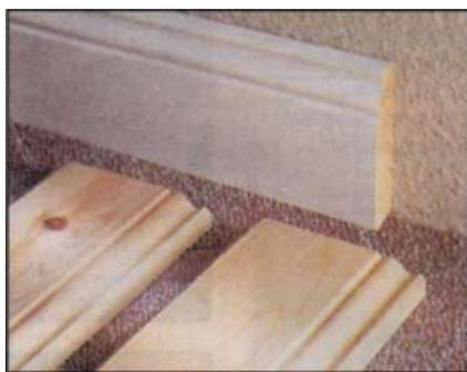
*Образцы классических плинтусов (сечением 18x96 мм) с профилированной карнизной частью. Изготавливают их из сосны. Они могут быть без отделки, а также с покрытием прозрачным или укывистым белым лаком.*
