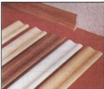
*Профилированные плинтусы (сечением 22x40 мм) из ценных пород древесины. С их тыльной стороны выбран паз. Крепят плинтусы на специальных зажимах.*
