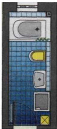
Ванная после переоборудования. Установка поперек новой более короткой ванны позволила не только более рационально разместить санитарно-технические приборы, но и выиграть пространство для стиральной машины.
