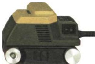
Компактная, легкая, сбалансированная ленточная шлифовальная машина ВВС 40 предназначена для эффективной обработки больших поверхностей деревянных и металлических деталей. Направляющие ролики точно отрегулированы, пружинный натяжитель позволяет быстро менять ленты.
