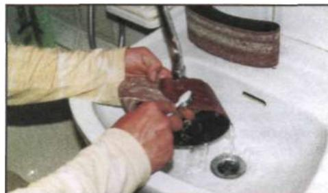
Удерживая ленту под струей теплой воды из крана, пыль тщательно смывают зубной щеткой сначала со стороны абразива, а затем и со стороны тканевой основы. Сухая древесная (дубовая, ясеневая, буковая, березовая) пыль смывается легко, чего нельзя сказать о засмолах, остающихся после шлифования хвойных пород древесины, следах клея и термoplastичного лака. Но это отдельная тема для разговора.
