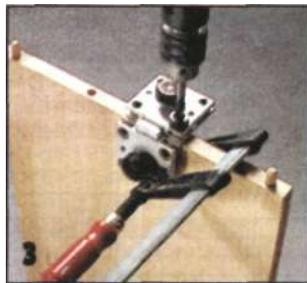
*На кромках полок толщиной 19 мм отверстия под шканты сверлят с помощью универсального кондуктора и сверла с ограничителем глубины сверления.*
