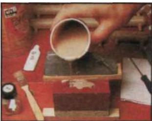
*Форму прижимают сверху грузом и ставят с небольшим наклоном, чтобы в отливках не осталось воздушных пузырьков.*
