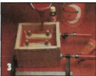
*Когда первый слой формовочной массы отвердеет, его поверхность промазывают воском, после чего опоку полностью заливают формовочной массой.*
