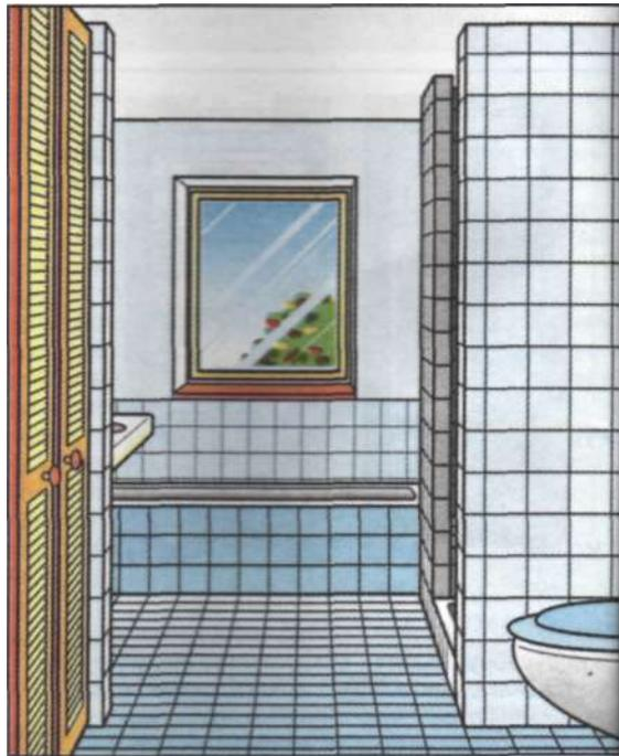
Размещение ванны у поперечной стены с окном высвобождает пространство для душа. Бойлер установлен в угловой нише между душевой кабиной и ванной. Стиральная машина — в углу за пластинчатыми дверями. Вместо одного умывальника стало два.
