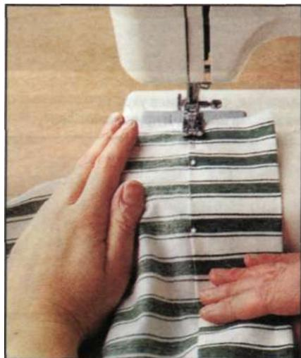
*Нижний край подкладки дважды подворачивают на ширину 5 см, проглаживают и прострачивают.*
