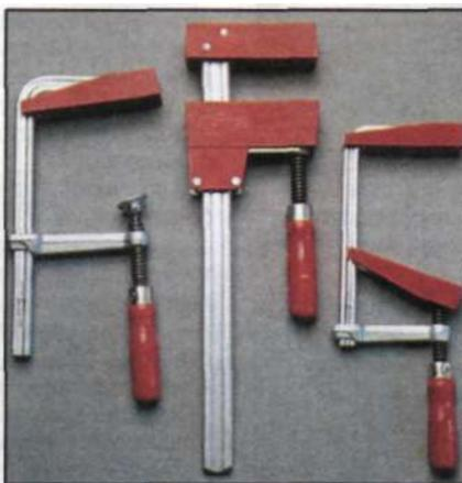
Струбцины «по дереву». Слева — столярная струбцина, в центре — струбцина для стягивания склеиваемых корпусных элементов, справа — струбцина для стягивания деталей, соединяемых по пласти. Упоры всех этих струбцин имеют защитные губки. Конечно, диапазон применения любой из струбцин значительно шире их конкретных назначений.
