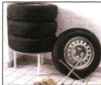
Зимние (летние) шины можно подвесить на прикрепленных к стене крюках и сложить штабелем в углу гаража. Однако чтобы было удобнее протирать пол, их лучше хранить на подставке, представляющей собой вырезанный из фанеры круг со стальными ножками высотой 20-30 см.
